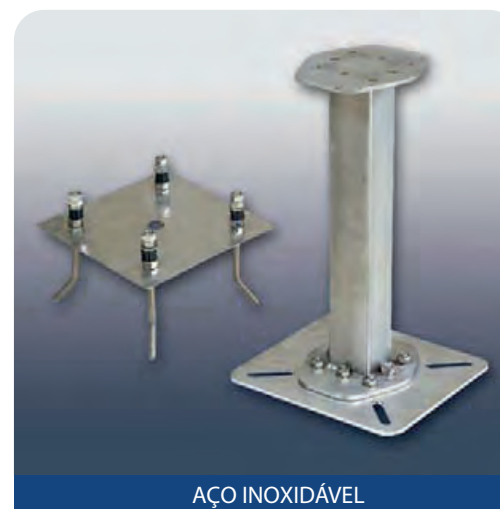
P-40 Poste inox fixação no solo através de pernos reguláveis para embutir em betão
